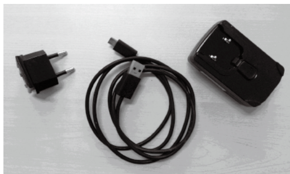
图 2 研究型教学用具示例:一个可拆卸插头的电源适配器
